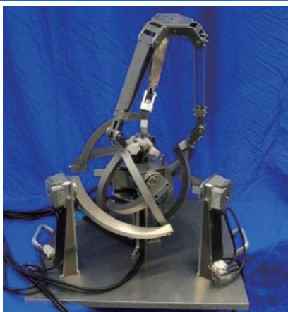
パラレルメカニズムはシリアルメカニズムと比べ、高速・高精度・高剛性であり、次世代のロボット機構として期待されています。従来、これらの特徴から、ドライブシミュレータのプラットフォーム、工作機械のワークテーブル、力覚提示装置等へ応用されています。パラレルメカニズムは複数の受動関節を持つ腕で出力を支える構造のため、広い実作業領域を実現するためには、リンク同士の干渉や特異点を考慮した設計が必要ですが、用途に合った最適な設計をすることで、従来のシリアルメカニズムを凌駕する性能を実現できます。
