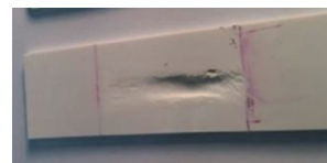
エロージョンにより損耗した材料の例
