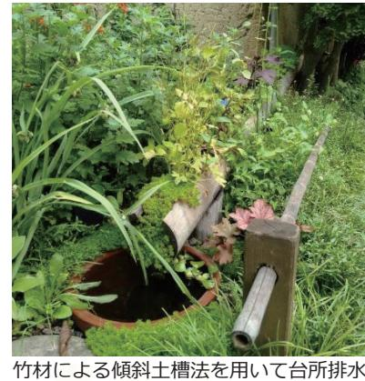
竹材による傾斜土槽法を用いて台所排水を浄化している(東京都調布市での実験)
