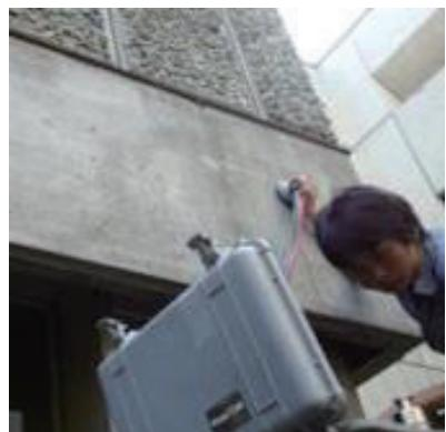
**表層透気試験による品質評価**
