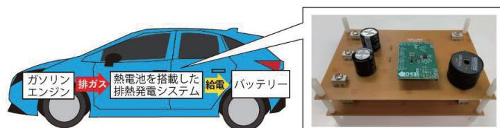
車両の排ガスの熱を利用したバッテリー給電システムの開発
