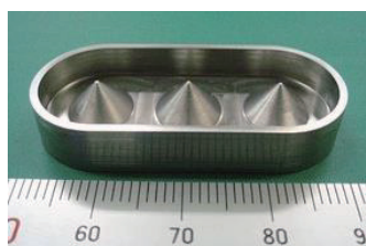
超硬合金の直彫り (V30, ダイヤモンド 電着砥石 #100 f=41\text{kHz} )
